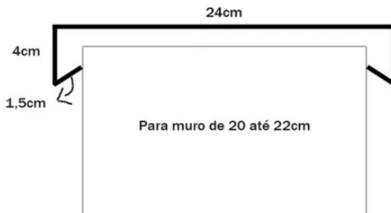
Figura 5 – Detalhe da pingadeira entre os prédios.
